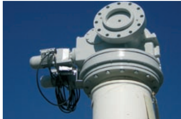
Mecanismo de apunte de heliostato de SENER.
